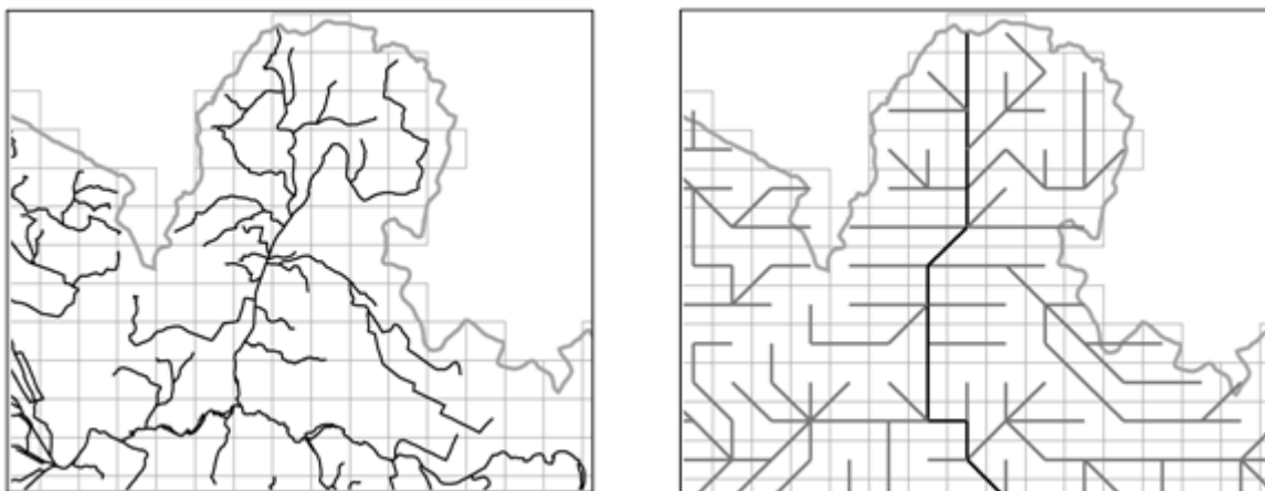
Abb. 4-1: Ableitung der Fließvernetzung (rechts) aus der Verschneidung der Teilgebiete (Raster) mit dem digitalen Gewässernetz (links).
